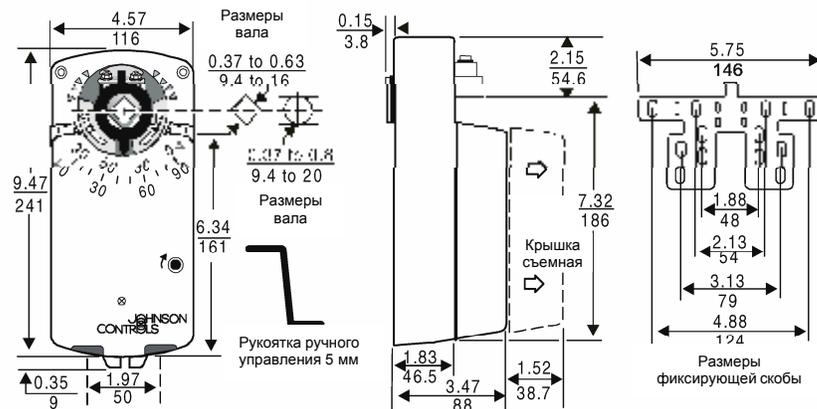
Рисунок 2: Габариты привода, фиксирующей скобы и ручьятки ручного управления, мм
