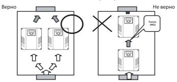
**Примечание:** следует уделить внимание правильности установки частотных преобразователей и вентиляторов на панели, в плане обеспечения рассеивания тепла.
