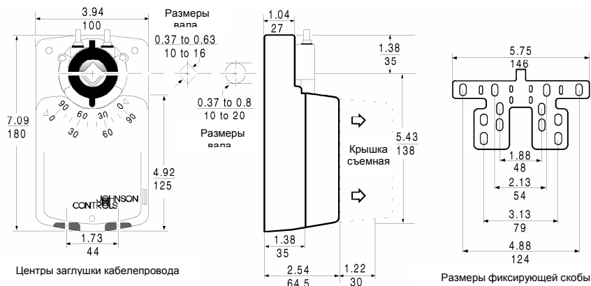
Рисунок 2: Габариты привода и фиксирующей скобы, мм
